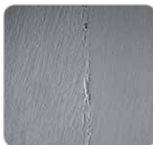
Fig. 3 Le MEB en grossissement de 150X affiche un verrouillage mécanique dans la zone d'engagement hexagonale entre les plats de l'implant et le pilier.
