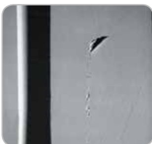
Fig. 2 Agrandissement de 50x au microscope électronique à balayage (MEB), montrant le contact parfait de l'implant à hexagone interne, à la fois au niveau de l'interface implant/pilier biseauté et de l'engagement hexagonal.
