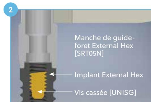
3. Insérer l'outil de dévissage manuel [USRT07] dans le manche de guide-foret External Hex [SRT05N]. Installer solidement la pointe du foret sur la surface de la vis cassée à l'intérieur de l'implant. Tourner lentement (en exerçant une pression modérée sur la vis) l'outil de dévissage manuel [USRT07] sur quatre ou cinq tours en direction opposée (sens anti-horaire). Pour aider à prévenir la déglutition accidentelle, passer la soie dentaire dans le trou de l'outil de dévissage.
